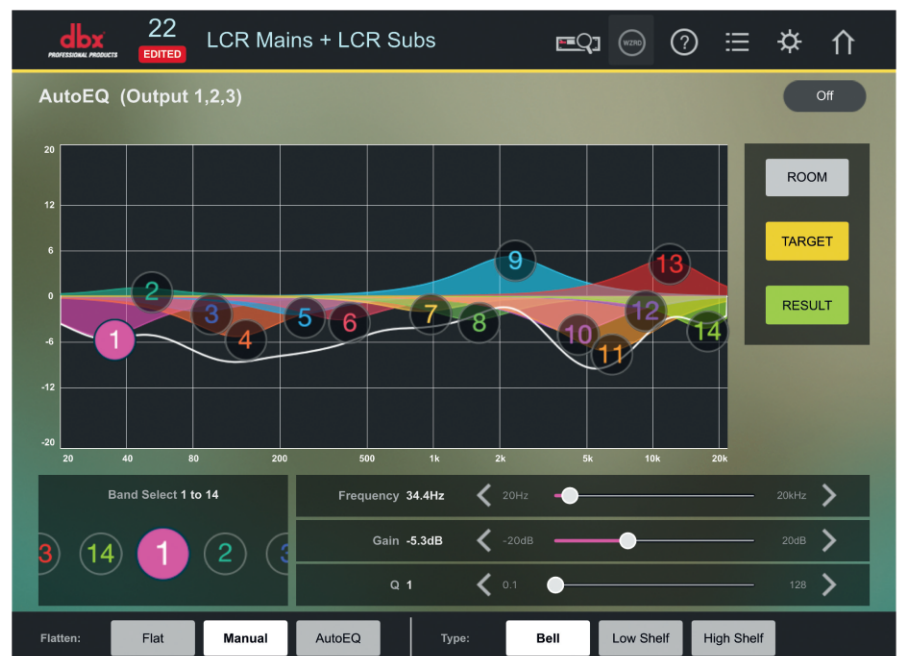
Der AutoEQ mit seinen 14 Bändern lässt sich auch mit einem Messmikrofon automatisch einstellen
