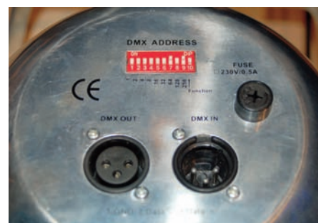
Mit den Dip-Schaltern werden die Adresse und Funktionen eingestellt.
