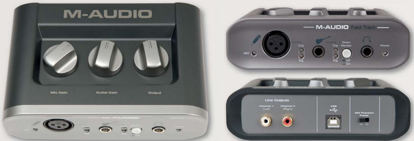
Die Ausstattung des M-Audio Fast Track gibt sich schlicht und schnörkellos. An Bord finden sich ein XLR- und ein Klinken-Eingang für Mikrofone und elektrische Instrumente sowie ein Kopfhörer-Ausgang und zwei Cinch-Buchsen für die Line-Ausgänge. Über die Drehregler auf der Oberseite sind Ein- und Ausgänge in der Lautstärke regulierbar. Neu im Vergleich zum Vorgänger-Modell ist die schaltbare Phantomspeisung des Mikrofon-Eingangs.
