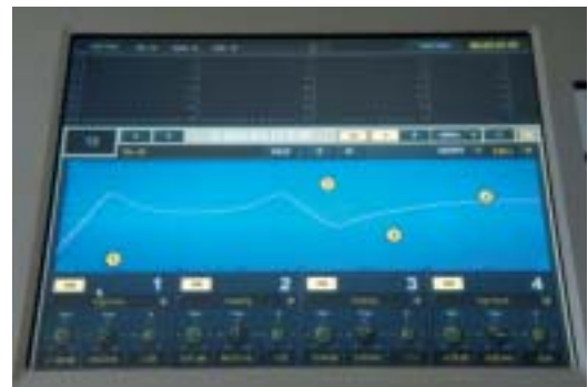
Der vierbandige, vollparametrische Equalizer ist in jedem Kanalzug integriert. Spannend wird es, wenn die verschiedenen Einstellungen Anfangen zu morphen.
