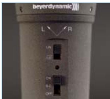
sung an (Schalterstellung „On“) oder ab (Schalterstellung „Off“) zu schalten. Ein nicht zu verachtendes Feature ist die Batterie-Test-Funktion, die sich hinter der Schalterstellung „B.C.“ („Battery Check“) verbirgt: Bei voller Batterie leuchtet eine LED oberhalb des Schiebeshalters und die Aufnahme kann beginnen. Aber nicht das Zurückstellen vergessen, sonst entlädt sich die Batterie.
