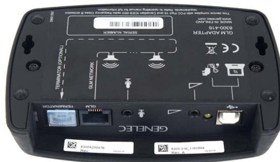
Das per USB an den Computer anschließbare Mess-Interface lässt sich via Netzwerkkabel im Daisy-Chaining mit den Monitoren verbinden.
