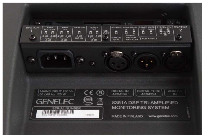
Auf der Rückseite des 8351 finden sich drei XLR-Anschlüsse – einer für Line-In, einer für AES/EBU-In und einer für AES/EBU-Out.
