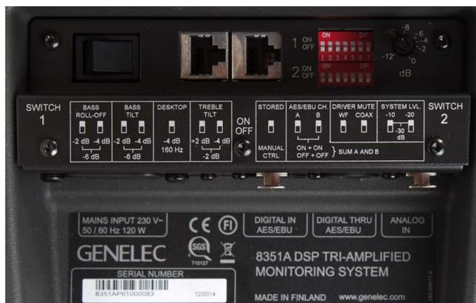
Die aus 14 Dipschaltern bestehende Filterklaviatur plus Drehregler lässt die sechs parametrischen Filter und die vier Shelvingfilter des 8351, wie auf der aufgedruckten Grafik beschrieben, bedienen.
