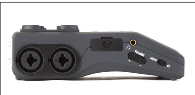
Die linke Flanke des H6 birgt zwei Combo-Buchsen, das SD-Kartenfach, den Kopfhö-erausgang samt Volume-Knöpfchen und den Power/Hold-Schalter.
