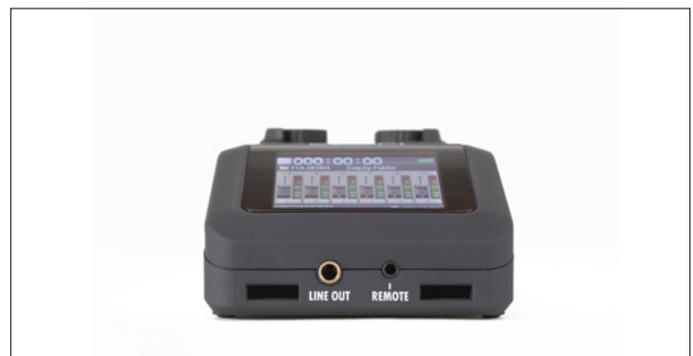
*Am Fußende des Recorders sind der Miniklinken Line- und der Remote-Ausgang zu finden.*
