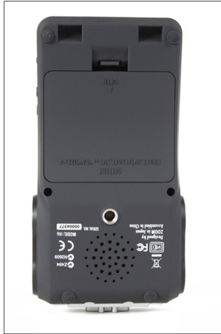
Auf der Rückseite finden sich Lautsprecher, Batteriefach und ein Kamera-Stativ-Gewinde.
