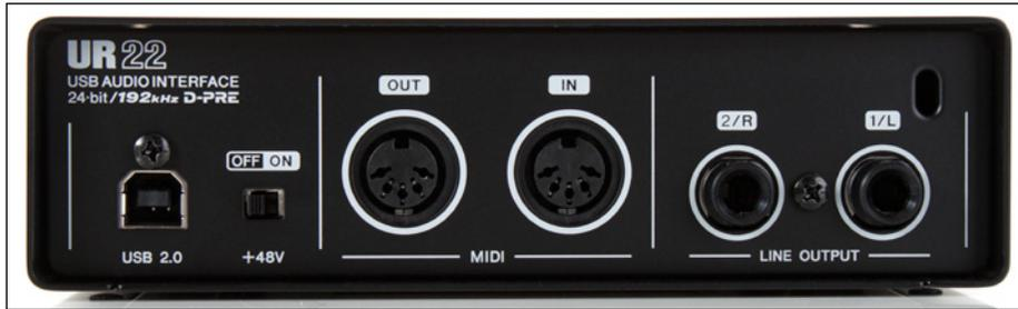
Das UR 22 wird per USB-Schnittstelle mit Strom versorgt, was es zu einem unkomplizierten Recording-Mobilisten macht.
