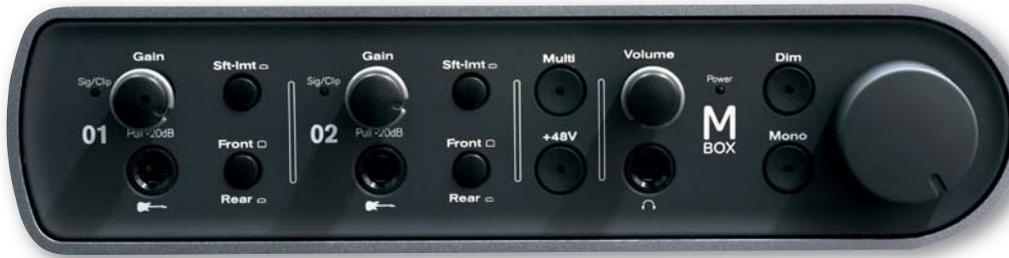
Die Mbox offeriert je zwei analoge Ein- und Ausgänge, die sich frontseitig im Gain einstellen lassen. Der Monitor-Out und die Kopfhörer-Buchse sind separat regulierbar. Besonderheit: Der Multi-Button erlaubt das Ausführen frei definierbarer Funktionen in Pro Tools 9 und per Soft Limit-Button wird ein digitaler Limiter zwecks Verhindern von Übersteuerungen in die Eingänge geschaltet.
