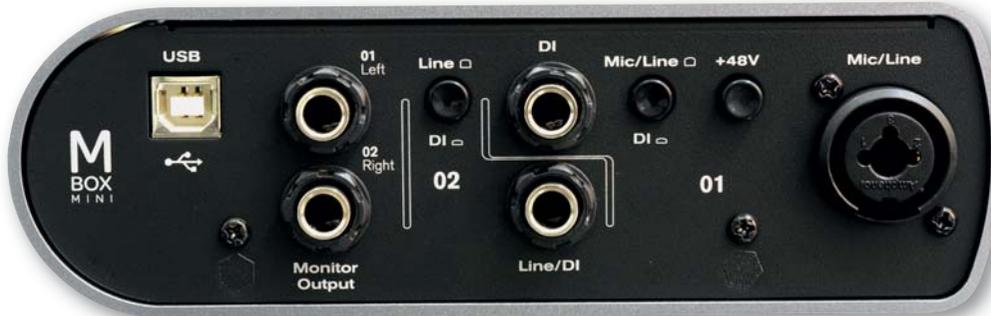
Das Arsenal an Anschlüssen gibt sich spartanisch, jedoch ausreichend. Lediglich ein Mikrofon ist via Combo-Buchse anschließbar. Dafür können bei Bedarf Line-Signale in Stereo oder zwei elektrische Instrumente simultan eingespeist werden. Die Stromversorgung erfolgt ebenfalls über die USB-Schnittstelle, die in Version 1.1 völlig ausreichend ist.
