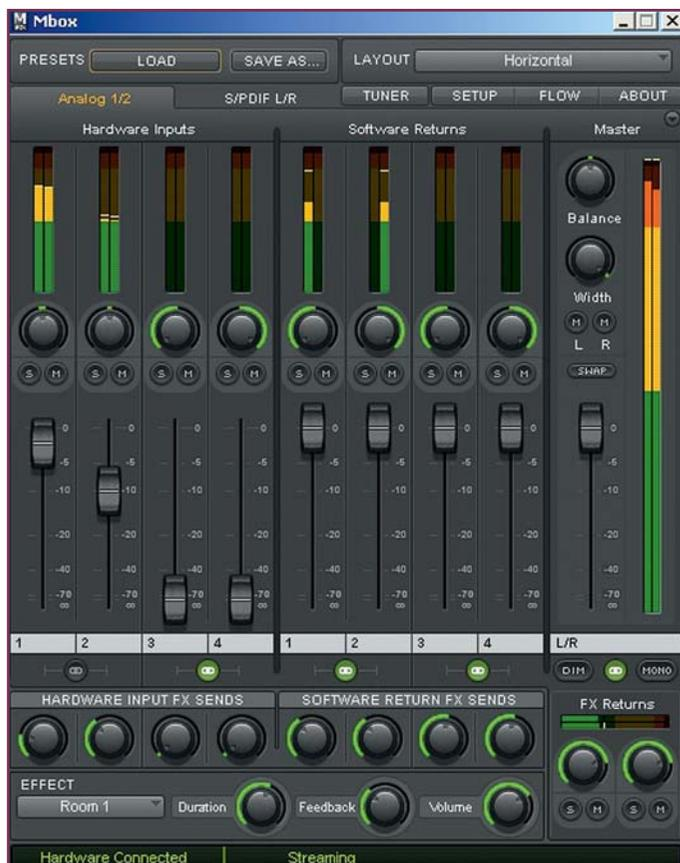
◀ Das Control Panel der Mbox erlaubt nicht nur das Einstellen und die Kontrolle über die analogen und digitalen Eingänge sowie die vom Computer gesendeten Ausgänge. Darüber hinaus lassen sich Raum-Effekte (Reverb, Delay) via Send-Weg auf den Master-Out einfügen. Über Menü-Buttons sind zusätzliche Features aufrufbar wie unter anderem ein Gitarren-Tuner und ein Dialog zum Einstellen von Samplingrate und -Buffer.
