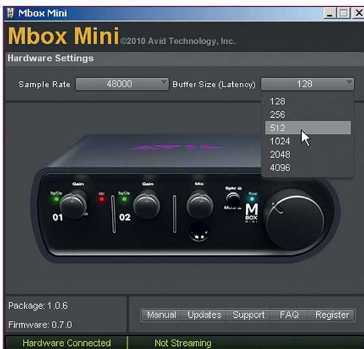
Das Control Panel der Mbox mini dient primär zum Einstellen von Samplingrate und -Buffer. Der Großteil an Einstellmöglichkeiten findet sich an der bewusst schnörkellos ausgelegten Hardware.
