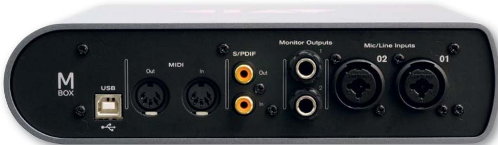
Die Rückseite der Mbox versammelt den Großteil der verfügbaren analogen Anschlüsse, die mit einer S/PDIF- und MIDI-Schnittstelle komplettiert werden. Die Stromversorgung erfolgt ausschließlich über die USB 2.0-Schnittstelle.
