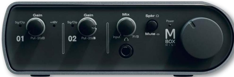
Die Mbox mini verfügt ebenfalls über zwei analoge Ein- und Ausgänge sowie einen Kopfhörer-Ausgang. Die Ausstattung und verfügbaren Features sind im Vergleich zur Mbox jedoch deutlich abgespeckt. Kopfhörer- und Monitor-Out sind gemeinsam mit dem großen Volume-Knopf regulierbar. Über den Mix-Regler ist die Balance zwischen Direkt-Signal und Computer-Return fürs Direct-Monitoring realisierbar.
