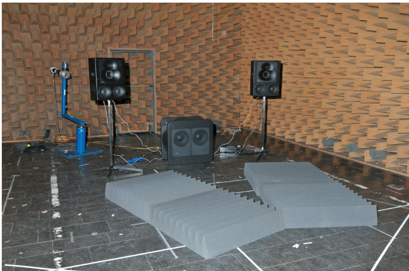
**Foto 1: 1238CF mit 7271A-Subwoofer beim Hörtest-Aufbau im reflexionsarmen Raum**
